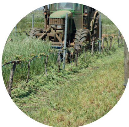
Figura 18. Tractor con segadora instalada en la toma de fuerza delantera. Obsérvese cómo la segadora proyecta el rastrojo hacia la línea del cultivo para generar un mulch.
