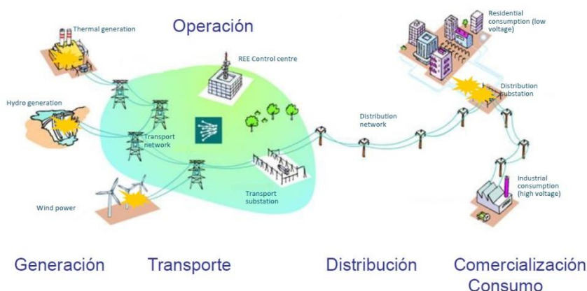
Figura 10. Los cuatro procesos de la energía
